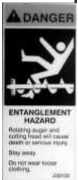
J000100 - DANGER ENTANGLEMENT HAZARD
