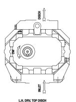
3. BOTTOM DRIVE SHAFT ARRANGEMENT "SPECIAL ORDER" (3-WAY UNIVERSAL) SPECIAL OGE OIL SLINGER REQUIRED FOR ASSEMBLY.
