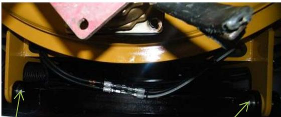
TANK PIVOT TUBE GREASE POINT
