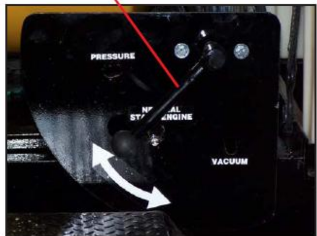
POIGNÉE DU SYSTÈME D'ÉCOULEMENT INVERSÉ
